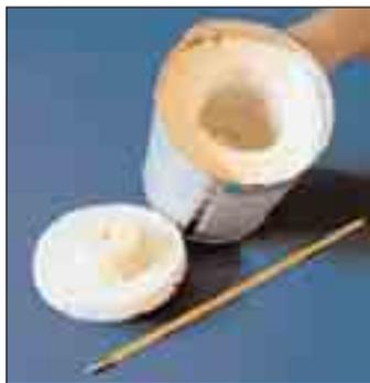
**Calorímetro.** Para medir la cantidad de energía absorbida o cedida en una reacción química, la transformación debe efectuarse dentro de un calorímetro. Este consiste en un recipiente hermético, fabricado de material aislante, al que se ajusta un termómetro.
